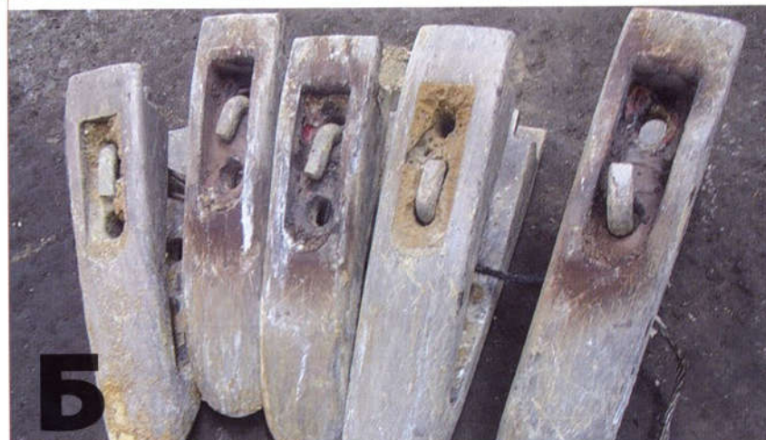
Рис. 4 – Упрочненные криогенной обработкой зубья ковша экскаватора до (а) и после (б) эксплуатационных испытаний
